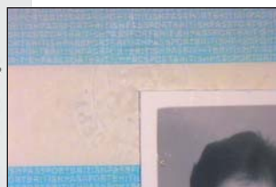
La iluminación coaxial revela elementos retrorreflectantes de seguridad.
